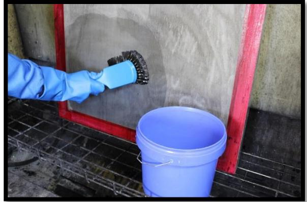
**醋酸胶膜熔融污渍** - 是一种在网版丝网上，容易辨别的浅色、半透明残留物。使用低腐蚀性鬼影清除剂，比如 **Autokleen Plus**，搭配 **Autosolve Industrial AF** 清洗剂可以有效清除此类污渍。
